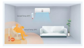
Der Sensor in der infrarot Fernbedienung misst die Raumtemperatur und sendet dieses Signal wieder nach dem Klimagerät. Dies schafft eine angenehme Temperatur und Luftstrom, dort wo die Fernbedienung sich befindet.
